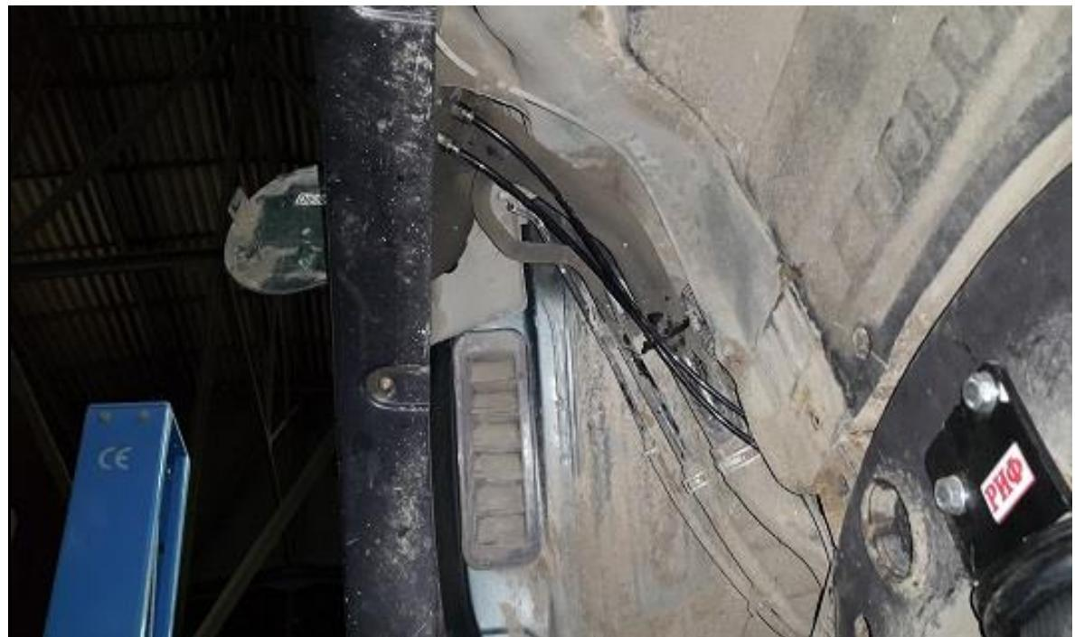
11. При помощи пластиковых хомутов закрепить пневмомагистраль вдоль тормозных трубок.
