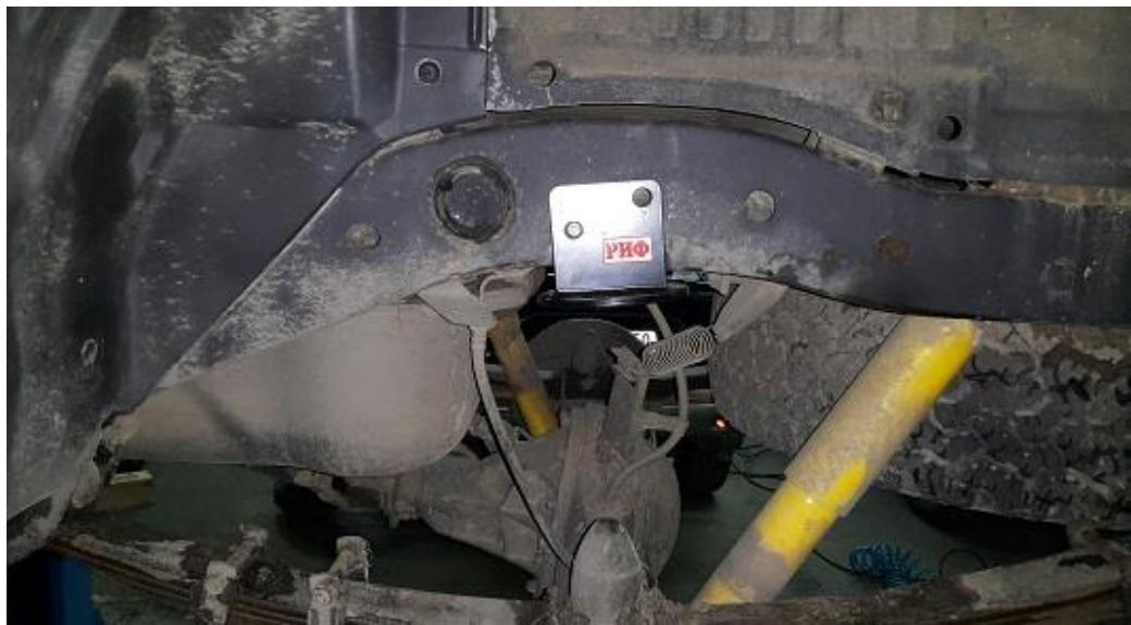
**ВНИМАНИЕ:** Кронштейны могут охватывать раму достаточно плотно, это происходит из-за того, что на раме имеется сварной шов и от машины к машине он может иметь разный размер.
