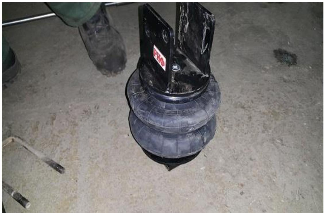
Треугольный вырез нижнего кронштейна должен быть развернут к центру автомобиля.
