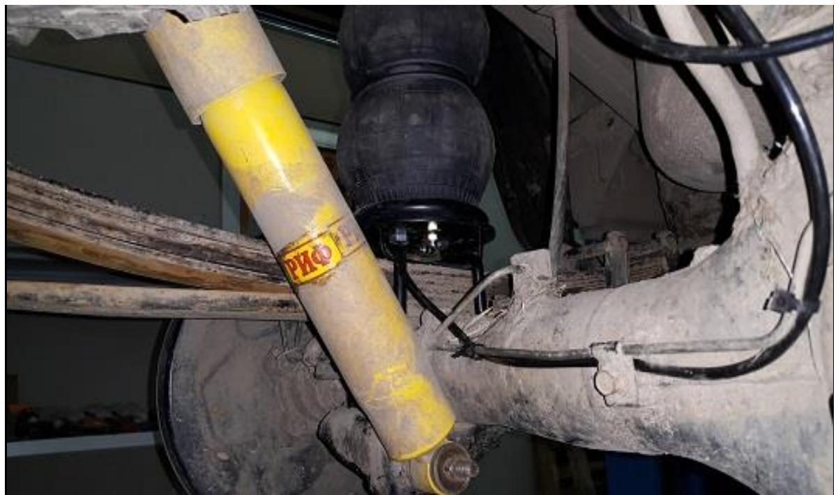
12. Установка пневмобаллона на другую сторону автомобиля производится аналогичным образом
