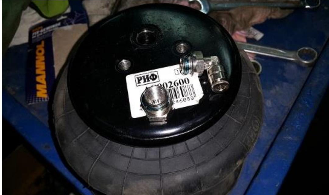
4. Установить пневмобаллон на кронштейны. Следить за расположением кронштейнов. Они должны находиться на одной плоскости.
