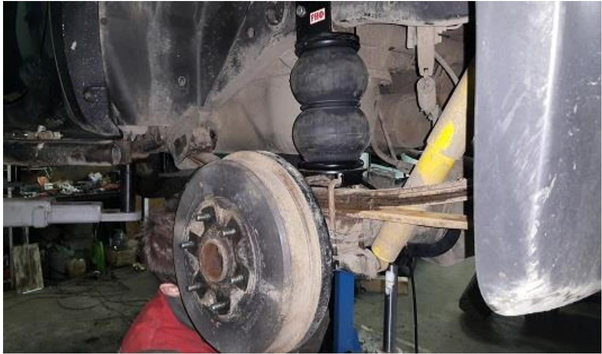
9. Затянуть гайки стремянок рессор.
